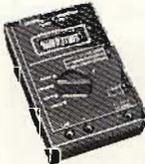
**Tester digitale «Hioki» Mod. 3201.** Display a cristalli liquidi. Circuiti integrati. Campi di misura e portate: Tensione c.c.: 200 mV - 2.000 mV, 20 V - 200 V, 200 V - 1.000 V. Tensione c.a.: 200 mV - 2.000 mV, 20 - 200 V, 200 - 500 V. Corrente c.c. e c.a.: 200  $\mu$ A - 2.000  $\mu$ A, 20 mA - 200 mA. Resistenza: 2 k $\Omega$  - 20 k $\Omega$ , 200 2000 k $\Omega$ . Alimentazione: 4 pile da 1,5 V, preternà 6 V c.c.. Dimensioni: 100x151x55. TS/2106-00
