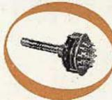
Commutatori rotativi. Per AF. Portata: 0,3 A - 125 V.c.a. Resistenza di contatto iniziale <10 mΩ. Rigidità dielettrica: 1400 V.c.a. Contatti: bronzo fosforoso argentato. Settori: 1 in bachelite Angolo tra due posizioni: 30°. Numero max di posizioni: 12.
