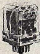
Relè standard di media potenza. Contatti: argento. Corrente max sui contatti: 10 A. Tensione max sui contatti: 250 V c.c.-c.a. Potenza di eccitazione: 1,2 W in c.c., 2,5 VA in c.a. Potenza di commutazione: 1000 W. con attacchi a spina octal-undecali.
