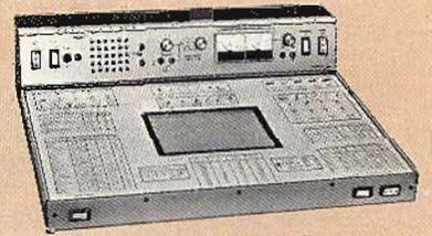
**Tavolo da laboratorio portatile Mod. Pigno 75.** Comprende un alimentatore stabilizzato regolabile da 3 - 14 V. Carico: 2,5 A. Un altoparlante da 3 W 5  $\Omega$ . Un generatore B.F. frequenze fisso 200 - 400
