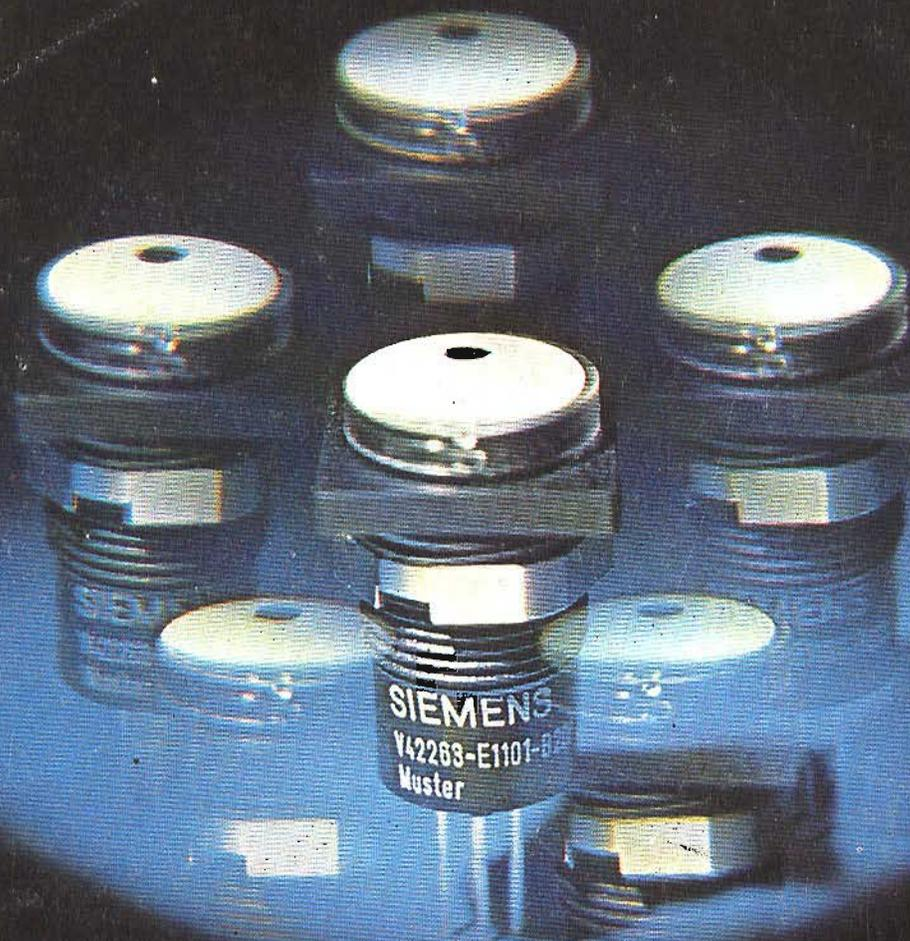
I tasti piezoelettrici fanno parte della nuova gamma di componenti elettronici presentati dalla Siemens; il loro trasduttore piezoceramico, sottoposto ad una leggera pressione (150 g), genera una tensione di circa 0,8 V. La deformazione, dovuta alla pressione, è inferiore a 0,5  $\mu\text{m}$ , perciò il tasto può essere definito come "sensore". Un diodo LED indica la posi-
