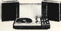
**Fono-Vallgia «Philips» Mod. GF-714.** Potenza d'uscita: 11 W musicali. Velocità: 33-45-78 giri/min. Arresto automatico a fine disco. Corredato di testina GP 215 con puntina in diamante regolabile da 3-6 g. Controllo separato del volume, e dei toni alti e bassi. Prese per registratore e sintonizzatore. Alimentazione: 220 V.c.a. Dimensioni: 445x109x257. ZH/2038-00
